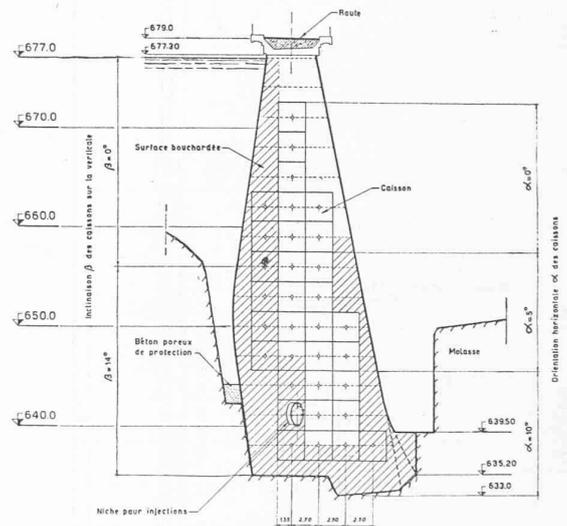
Fig. 8. — Coupe dans l'axe d'un joint. Echelle 1 : 700.
