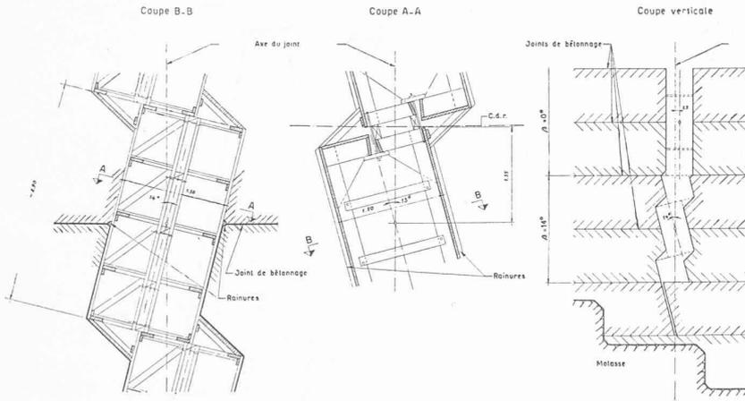
Fig. 6. — Détails des coffrages à caissons. Echelle 1 : 87,5.
