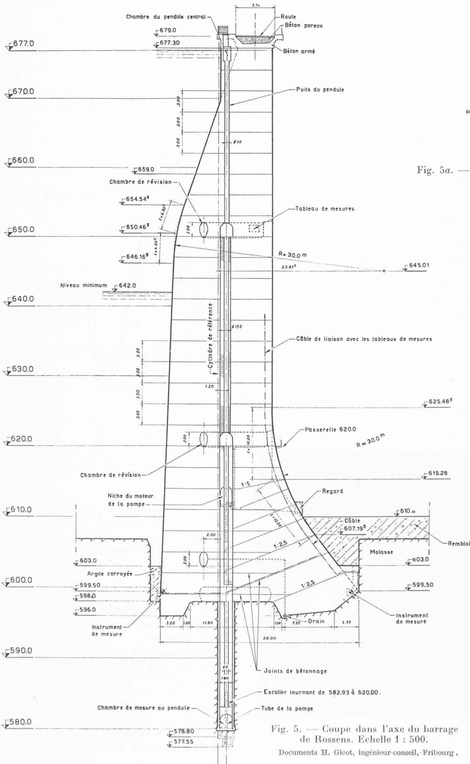
Fig. 5. — Coupe dans l'axe du barrage de Rossens. Echelle 1 : 500.
