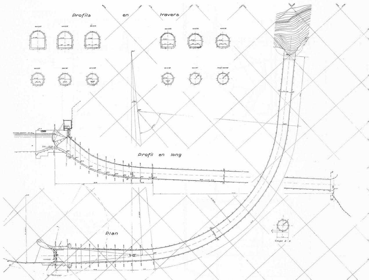
Fig. 10. — Evacuateur de crues de surface. Plans, profil en long, coupes-types. — Echelle 1 : 1200.
