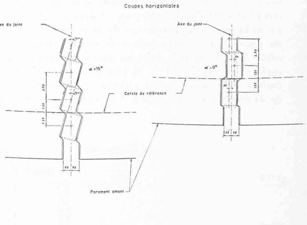
Fig. 7. — Disposition de joints provisoires. Echelle 1 : 350.
