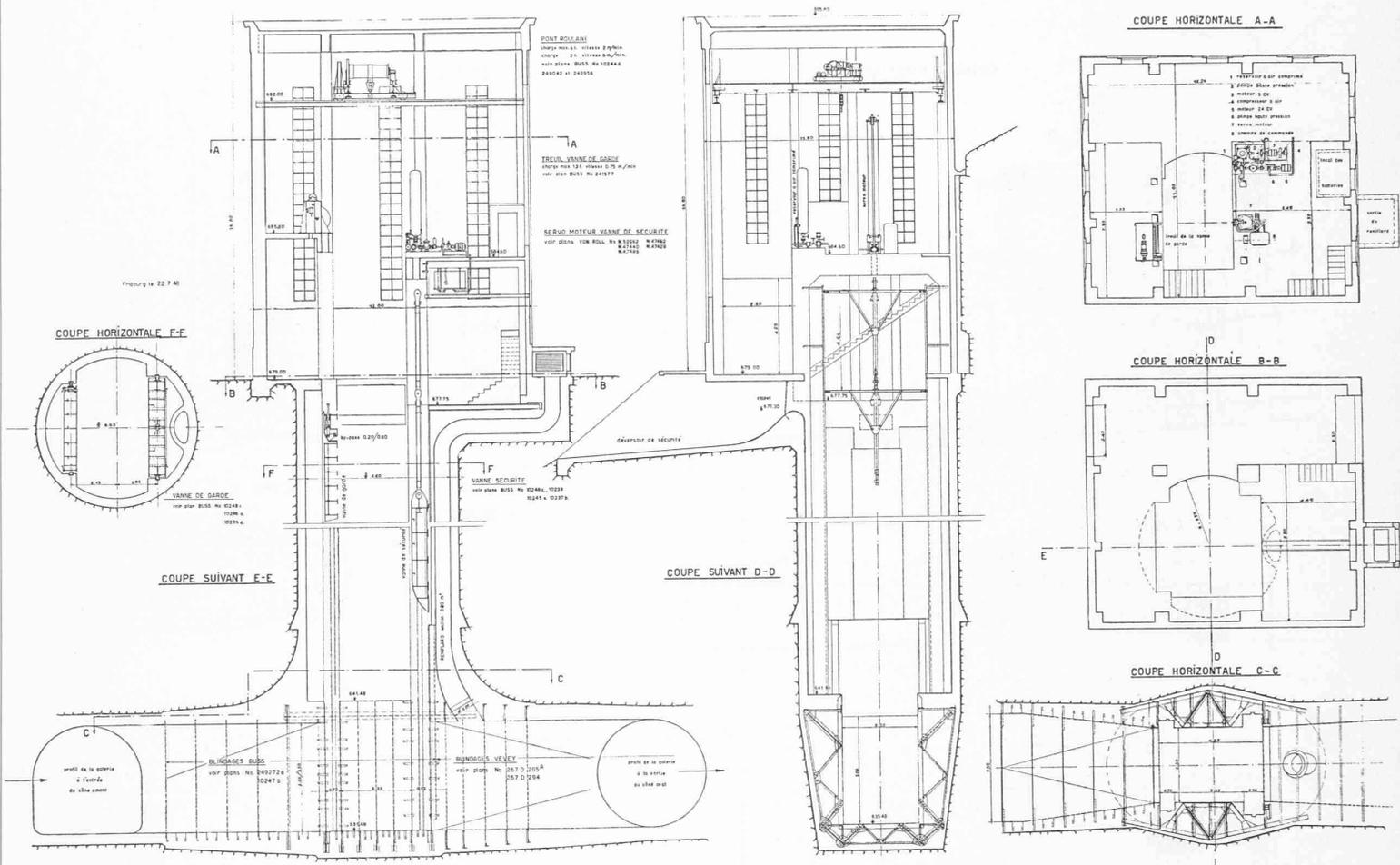
Fig. 16. — Bâtiment et puits des vannes de la prise d'eau. — Echelle 1 : 300.
