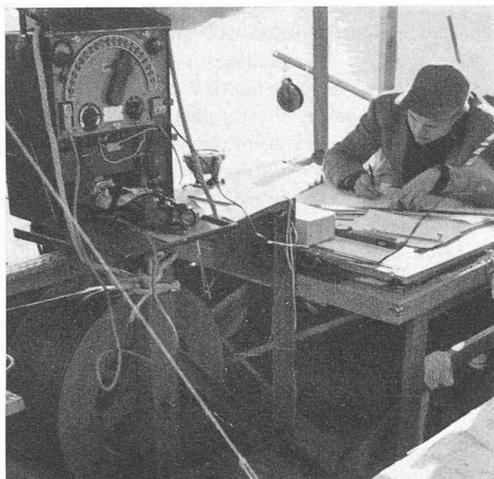
Fig. 13. — Table à dessin, téléphone et treuil de sonde.
