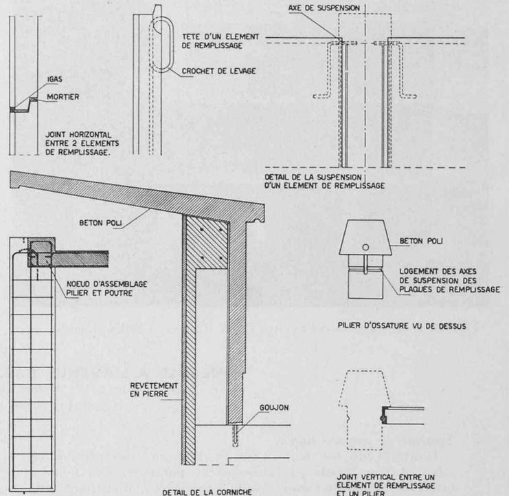
Fig. 69. — Détails divers de fabrication. Echelle 1 : 30.
