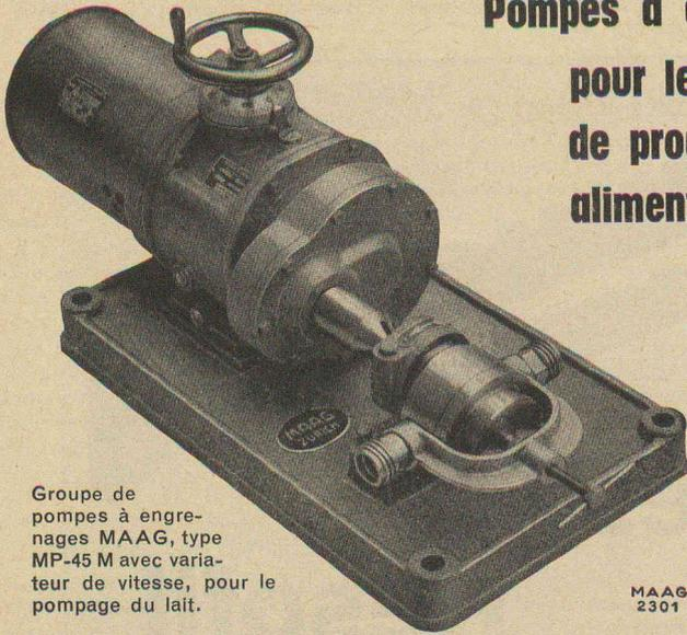
Groupe de pompes à engrenages MAAG, type MP-45 M avec variateur de vitesse, pour le pompage du lait.
