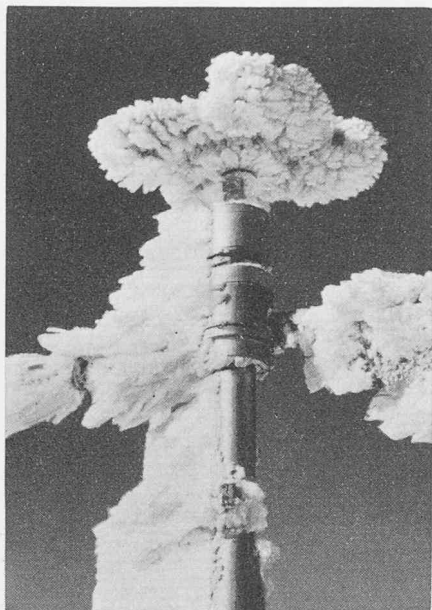
Fig. 13. — Le tourniquet ou robinson abandonné sciemment sans chauffage est bloqué par une carapace de givre en quelques minutes.
