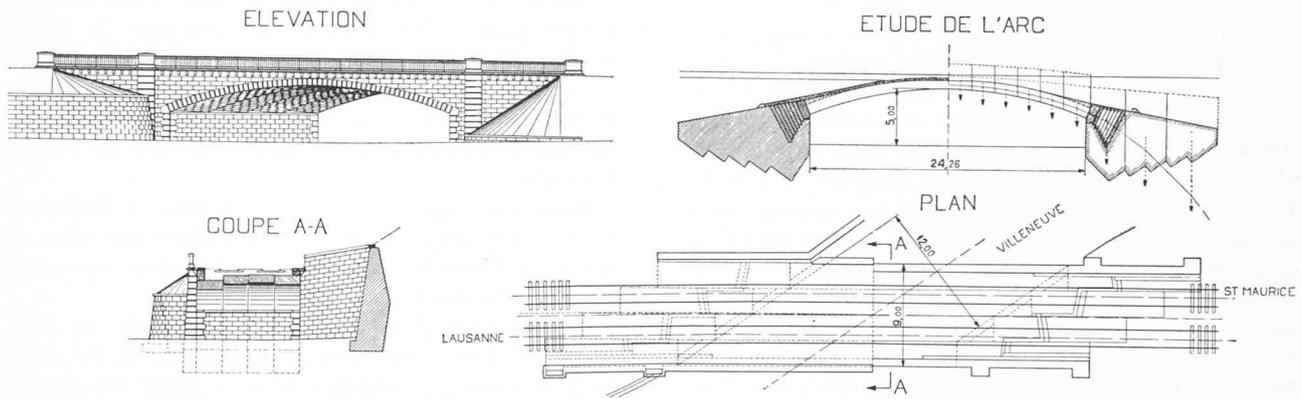
Fig. 2. — Projet de 1907. — Passage inférieur voûté.
