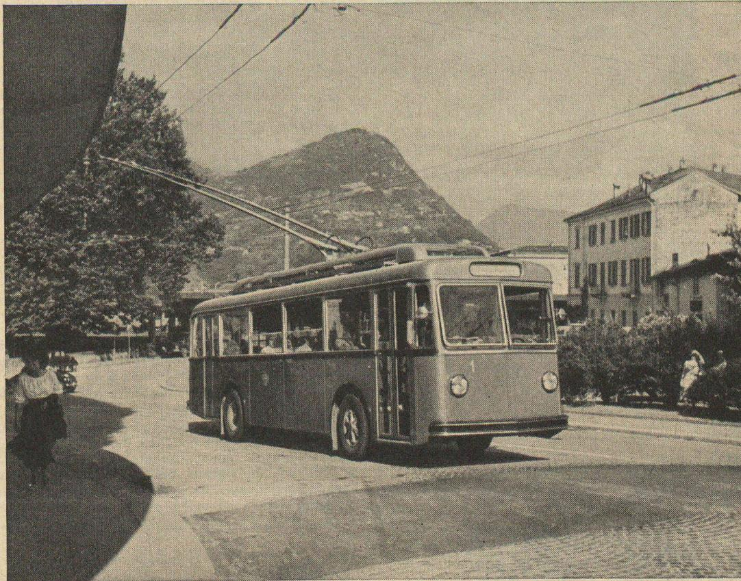
*Un des trolleybus de 144 ch, 1000 V courant continu, livrés par Sécheron
