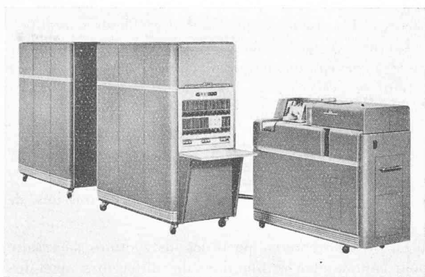
Fig. 4. — Vue d'une calculatrice à tambour magnétique, type 650.
