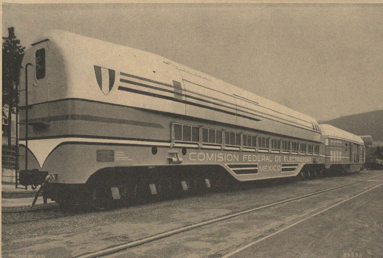
Cette figure montre l'une des deux centrales mobiles sur rails construites par la Société anonyme Brown, Boveri & Cie pour la Comision Federal de Electricidad, à Mexico, et composées chacune d'une turbine à gaz entraînant un alternateur de 6200 kW, 60 Hz (au premier plan), d'un transformateur pouvant fournir trois tensions, d'un poste de commande et de l'appareillage nécessaire (au fond). Voir page 276 du présent numéro.
