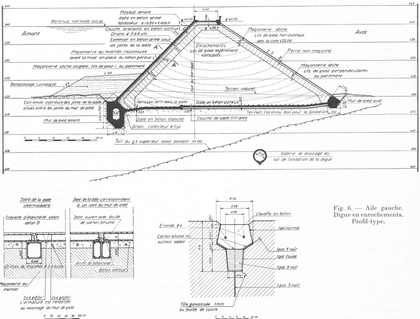
Fig. 6. — Aile gauche. Digue en enrochements. Profil-type.
