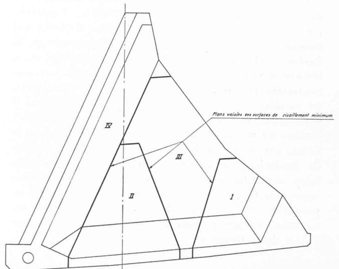
Fig. 4. — Découpage des contreforts pour l'exécution.
