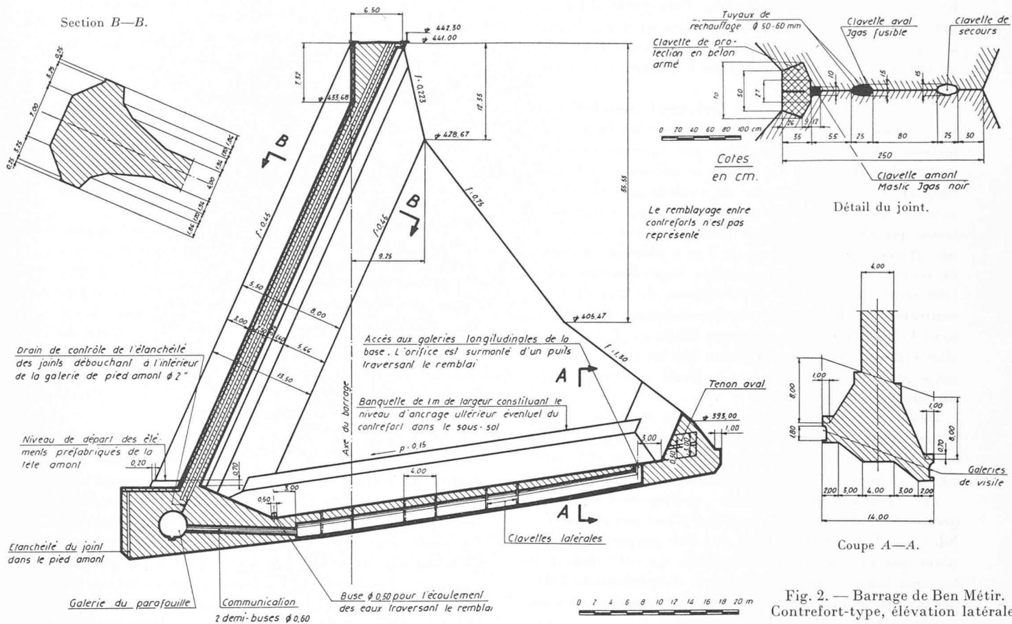
Fig. 2. — Barrage de Ben Météir. Contrefort-type, élévation latérale
