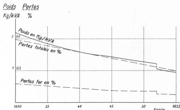
Fig. 1. — Poids et pertes de gros transformateurs 1930-1955.
