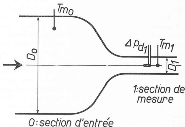
Fig. 4. — Principe de la détermination du coefficient d'échauffement  $r$ .
