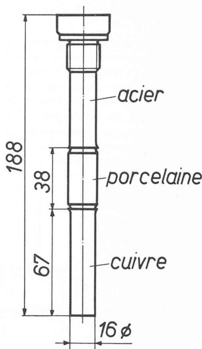
Fig. 3. — Douille de protection pour thermomètre à mercure.
