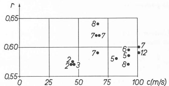
Fig. 6. — Valeurs mesurées du coefficient d'échauffement  $r$  d'un thermomètre à mercure placé dans la douille de protection de la figure 3, en fonction de la vitesse d'écoulement  $c$ . Le poids attribué à la mesure est inscrit à côté de chaque point de mesure.
