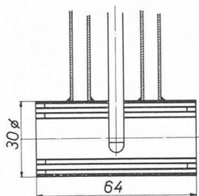
Fig. 1. — Thermomètre de King (1) pour hautes températures.
