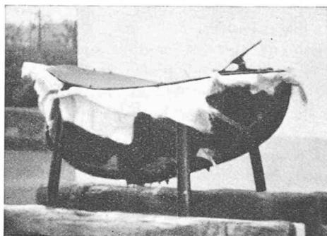
Fig. 2. — Moule métallique avec couvercle pour la fabrication en « bag molding » de capots pour triporteurs.
