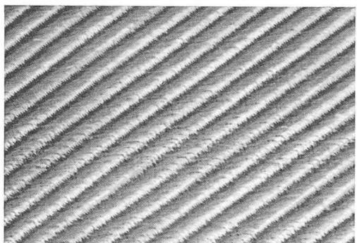
Fig. 12. — Tissu Vetrotex n° 229 armure sergee à haute déformabilité pour pièces profondes.
