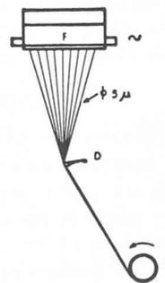
Fig. 6. — Fabrication par étirage mécanique de la Silionne.
