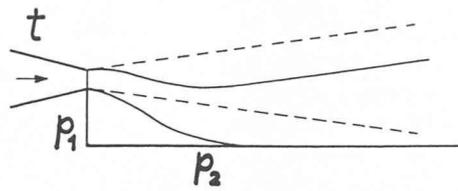
Fig. 3. — Nappe d'air collant contre une paroi.
