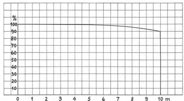
Fig. 10. — Répartition de la pression totale dans un canal.
