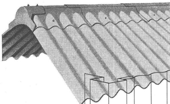
Le revêtement qui défie les intempéries pour toits et façades de fabriques, hangars d'aviation, halles d'exposition, dépôts, etc. Le poids léger des plaques permet une construction économique. Exécution de toits sheds plats et arqués avec bon réfléchissement de la lumière à l'intérieur.
