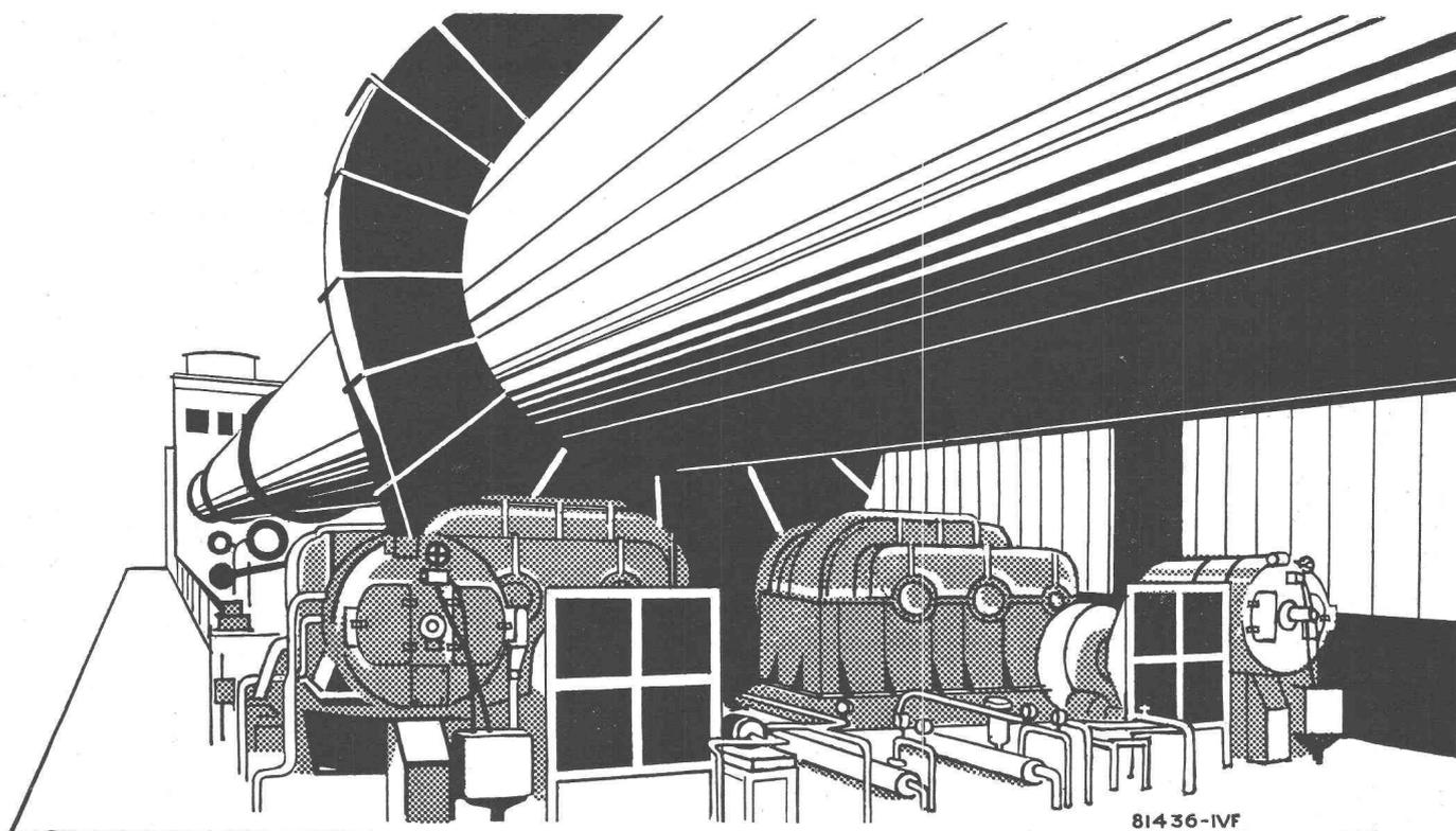
*Deux moteurs triphasés shunt à collecteur de 220 ch entraînent à vitesse réglable de façon continue un des plus grands fours rotatifs du monde*
