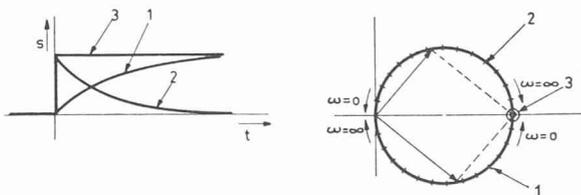
fig. 15 a Réponse indicielle      fig. 15 b Réponse harmonique
