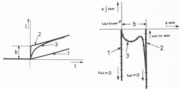
fig. 12 a Réponse indicielle      fig. 12 b Réponse harmonique
