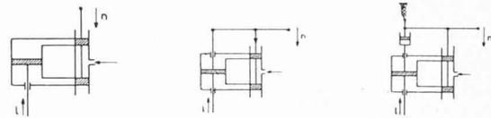
Servo-moteur sans avertissement fig. 11 a      Servo-moteur avec asservissement rigide fig. 11 b      Servo-moteur avec asservissement glissant fig. 11 c
