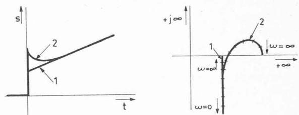
fig. 16 a Réponse indicielle      fig. 16 b Réponse harmonique
