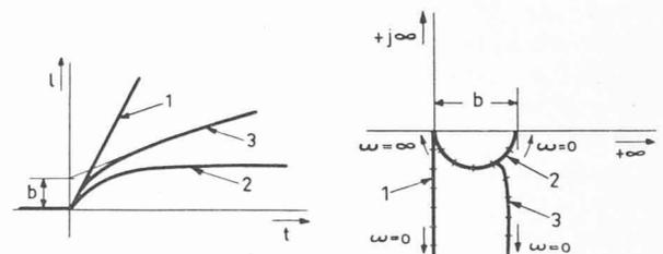
fig. 13 a Réponse indicielle      fig. 13 b Réponse harmonique
