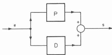
Fig. 14. — Principe de l'introduction d'une chaîne d'anticipation.
