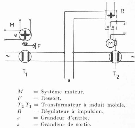
Fig. 20. — Régulateur différentiel avec asservissement électrique.
