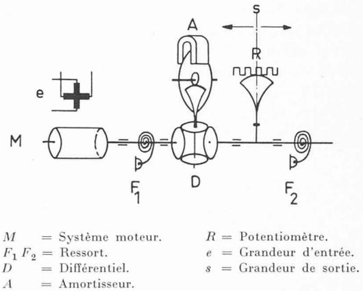
Fig. 21. — Régulateur différentiel avec rotation.
