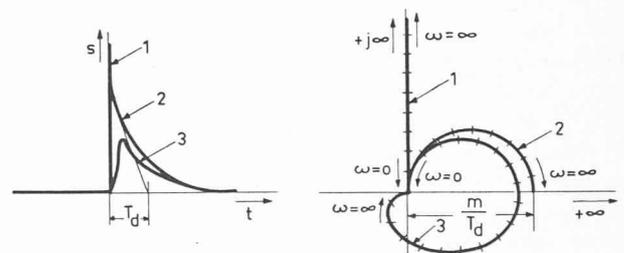
fig. 9 a Réponse indicielle      fig. 9 b Réponse harmonique
