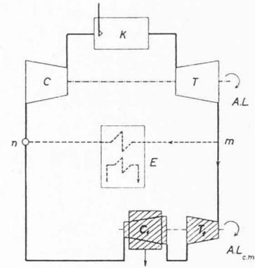
Fig. 6. — Schéma d'installation simple de turbine à gaz.
