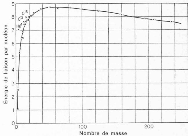
Fig. 1. — Cette courbe montre immédiatement qu'on obtient un gain d'énergie d'environ 1 MeV par nucléon par fission d'un noyau lourd ( $A \simeq 240$ ) en deux fragments voisins de  $A = 110$ .
