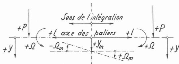
Fig. 1. — Sens positif des vecteurs  $P$ ,  $\Omega$  et  $Y$  en fonction du sens de l'intégration.
