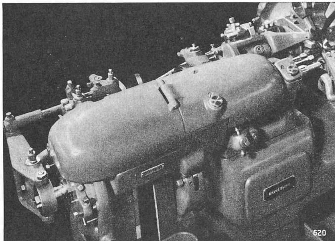
Fig. 9. — Appareil perceur-taraudeur à trois broches employé entre autres dans le décolletage de l'arbre de barillet.
