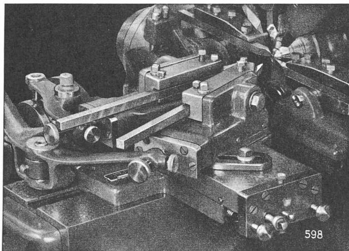
Fig. 10. — Piqueur double 6° et 25° à coulisses pour le décolletage d'axes de balanciers.
