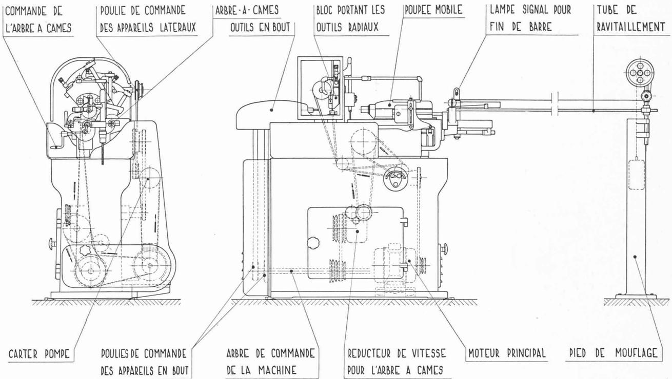
Fig. 2. — Schéma fonctionnel du tour automatique.
