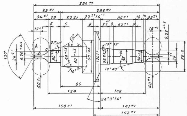
Fig. 4. — Axe de balancier avec cotes et tolérances.
