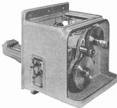
Fig. 14c. — Unité d'entraînement des arbres à cames avec engrenages interchangeables pour cycles de production et dispositif d'accélération permettant d'éliminer les temps improductifs.
