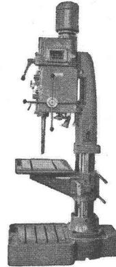
Constructions robustes, modernes et très maniables. Perceuses d'établi, sur colonne, sur montant et en ligne avec capacité de perçage allant jusqu'à 50 mm dans l'acier St.50.11. Avance à main ou automatique. Vitesses de broche à réglage progressif ou avec engrenages baladeurs.
