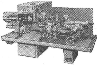
Avec présélection et commande hydraulique des vitesses.
