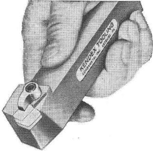
Les plaquettes « throw away » éliminent les frais d'affûtage. Plaquettes carrées avec 8 et plaquettes triangulaires avec 6 arêtes coupantes, rendent le changement d'outil possible en quelques secondes. Élimination de cassage d'outil causé par tensions de soudure.
