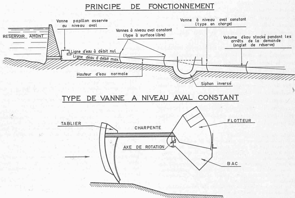
Fig. 2. — Schéma de commande par l'aval.
