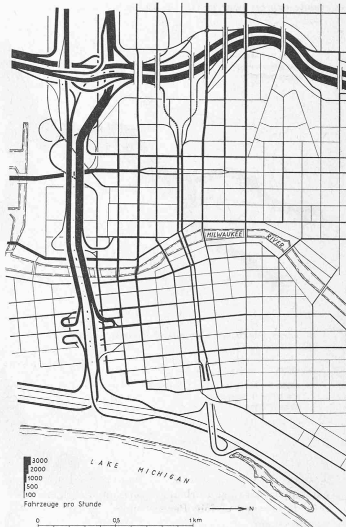
Fig. 11. — Même région. Charge de pointe en 1980 avec les routes express. Etudes du Bureau Ammann & Whitney, à New York.
