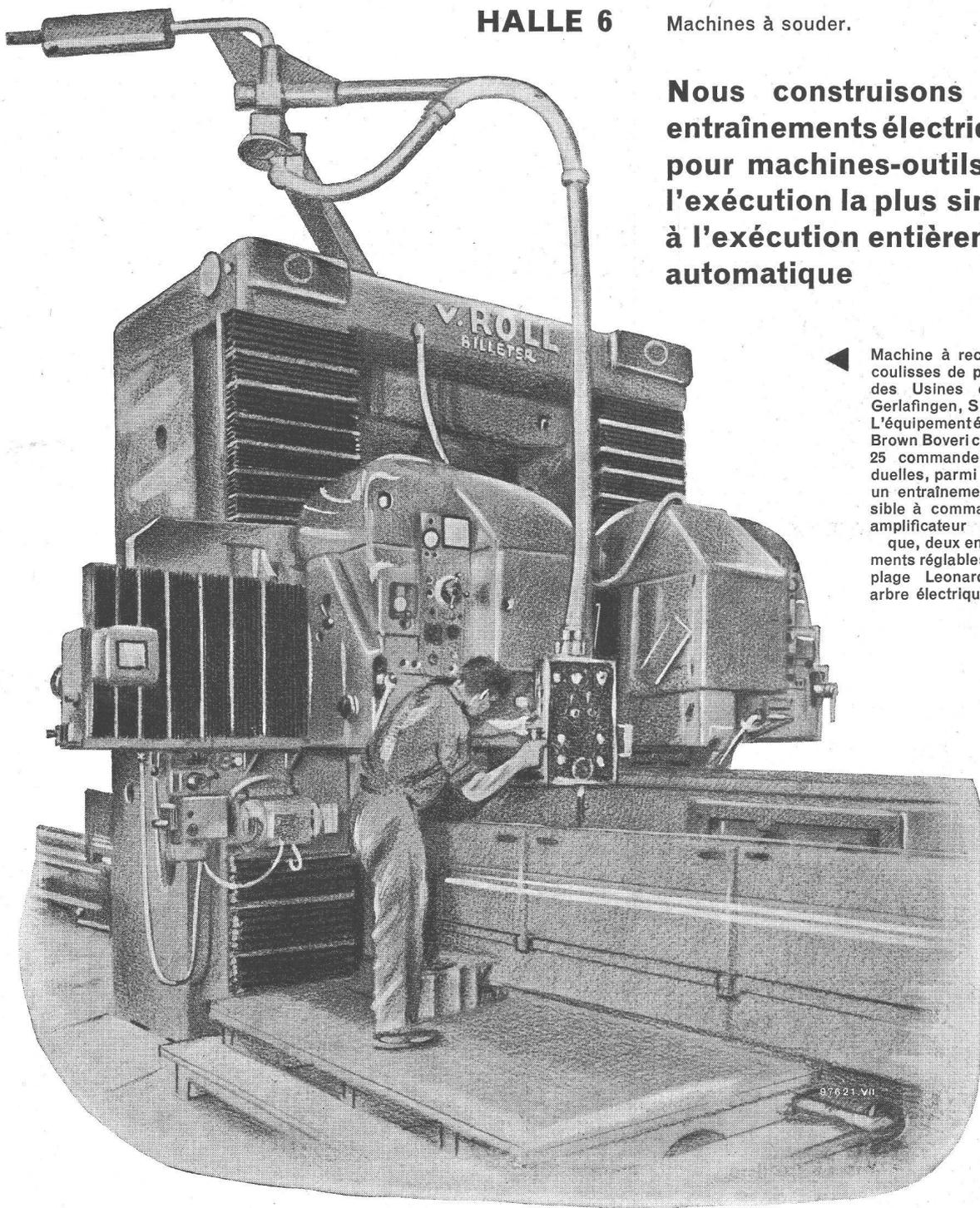
◀ Machine à rectifier les coulisses de précision, des Usines de Roll, Gerlafingen, Suisse. L'équipement électrique Brown Boveri comprend 25 commandes individuelles, parmi celles-ci un entraînement réversible à commande par amplificateur magnétique, deux entraînements réglables en couple Leonard et un arbre électrique.
