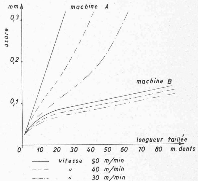
Fig. 1. — Fraises vis en acier rapide à profil non rectifié, trempées ensemble dureté 66 Rc, module 1.
