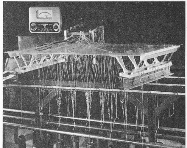
Fig. 2. — Essai sur modèle réduit, en plexiglas, d'un pont biais avec appuis triangulés. Echelle du modèle 1 : 50.
