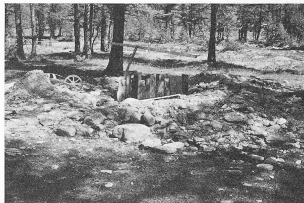
Fig. 2. — Puits de reconnaissance dans la plaine d' Eggen avec matériaux extraits, destiné aux essais de pompage.
