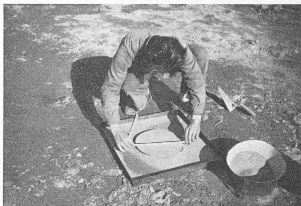
Fig. 11. — Détermination de la densité « in situ » — arasage du sable.
