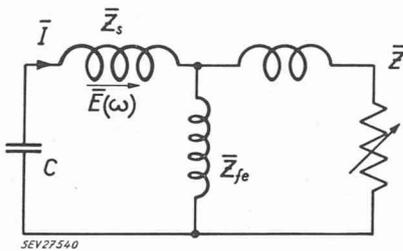
Fig. 2. — Schéma équivalent d'une phase du moteur polyphasé.
