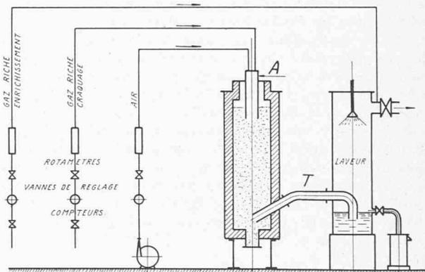
Fig. 3. — Installation de craquage autothermique et catalytique étudiée par *Gaz de France* (type P<sub>2</sub>).
