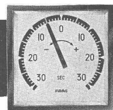
Dans une centrale électrique, on contrôle la régularité de la fréquence à l'aide du fréquence-mètre FAVAG.
