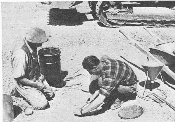
Photo n° 9. — Détermination de la densité sur place.
