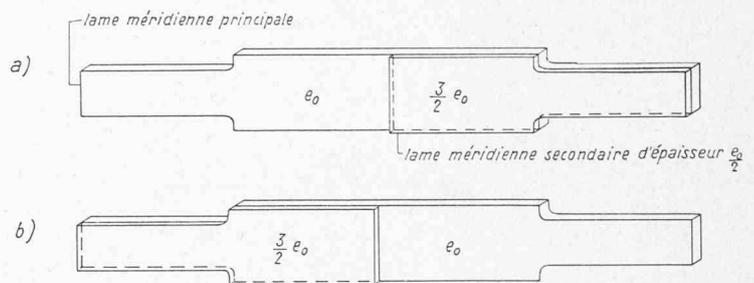
Fig. 2 a, b. — *Lame méridienne secondaire* de la plaque représentée fig. 1 A, placée successivement dans deux positions sur une *lame méridienne principale*, pour permettre de photographier les isoclines en éliminant les isochromes.
