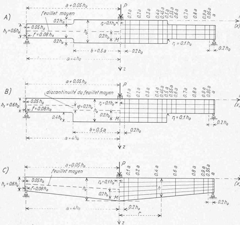
Fig. 1 A, B, C. — Coupe axiale des trois modèles de plaques étudiées (respectivement, vue des modèles des poutres correspondantes) précisant également les points situés aux intersections de deux systèmes de droites  $\gamma$ , où les tensions ont été déterminées ( $a = 4 h_0$ ).
