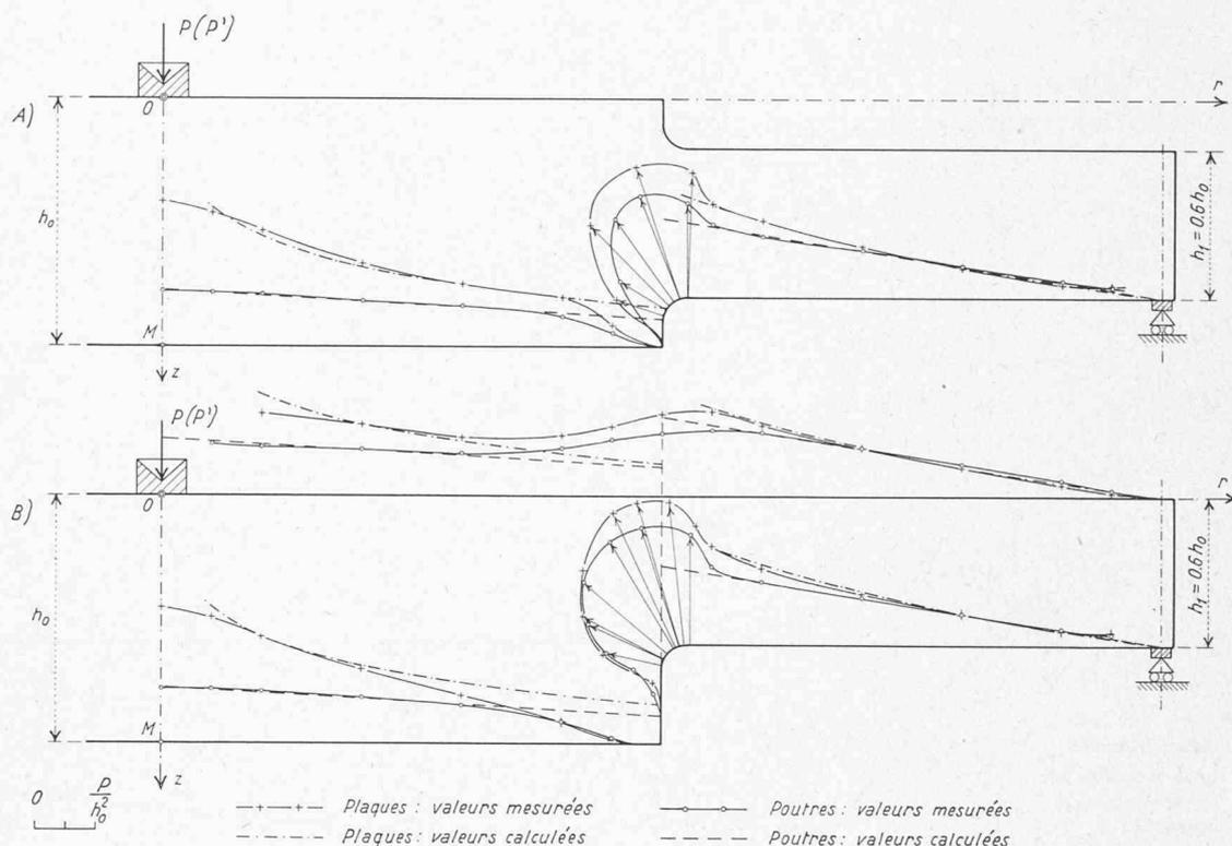
Fig. 11 A, B. — Diagrammes des valeurs, mesurées et calculées, des tensions normales méridiennes le long du contour d'une section axiale, pour les plaques et les poutres des figures 1 A et 1 B.
