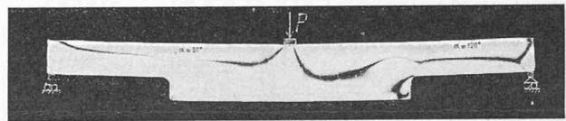
Fig. 3. — *Plaque* représentée figure 1 B. *Isoclines*  $\alpha = 30^\circ$  et  $\alpha = 120^\circ$  de la *lame méridienne principale*, photographiées selon le procédé décrit § 1.
