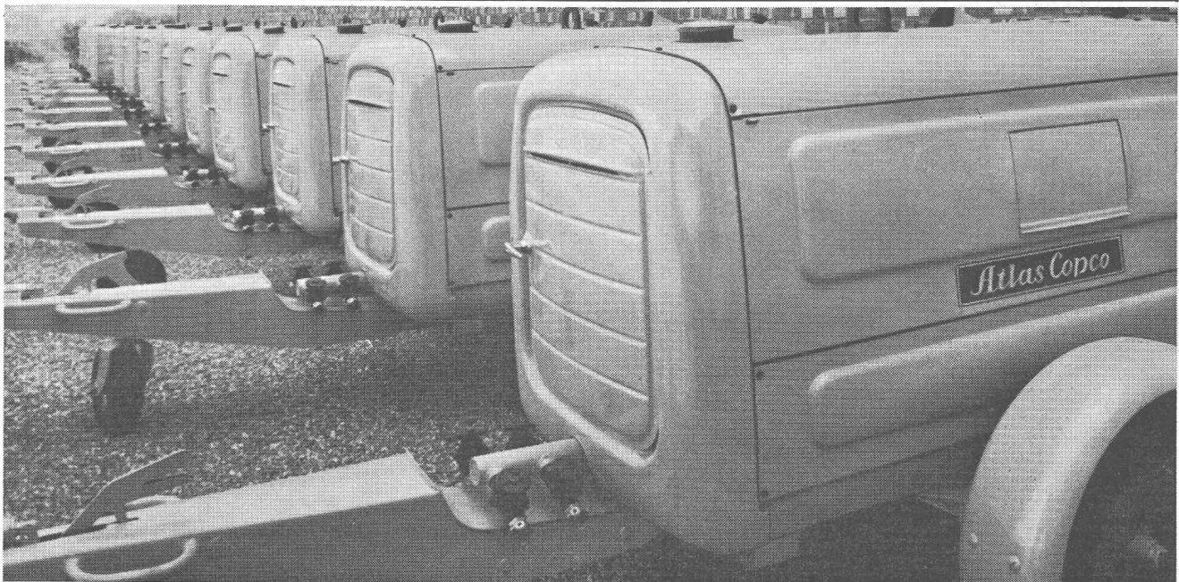
Relation avantageuse poids - rendement - consommation de carburant. Intégralement refroidis par air. Construction simple — entretien aisé. Dispositif de réglage Fuelmiser. Démarrage électrique par batterie de 12 V. Accouplement centrifuge automatique. Compteur d'heures mécanique.
