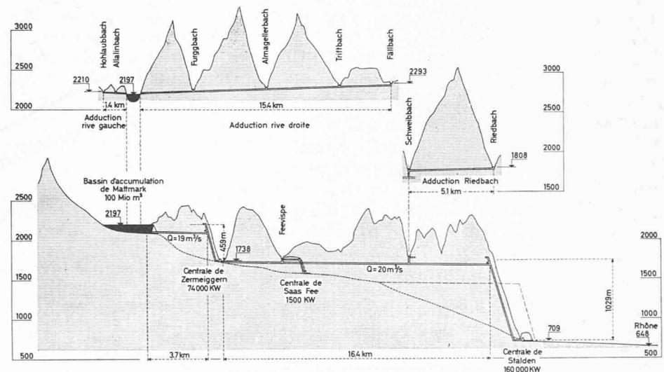
Fig. 12. — Profil en long de l'ensemble de l'aménagement.
