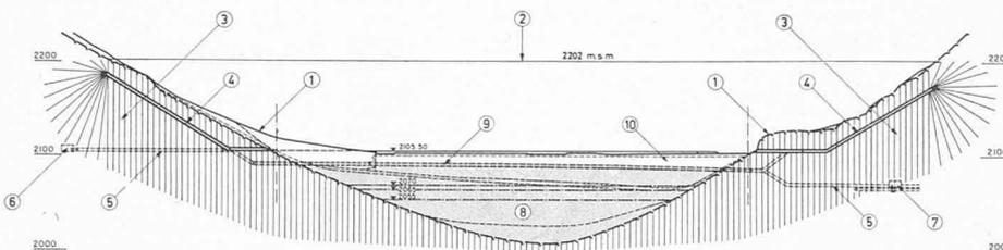
Fig. 10. — Coupe en travers de la vallée, avec le voile d'injection (vue vers l'aval).
