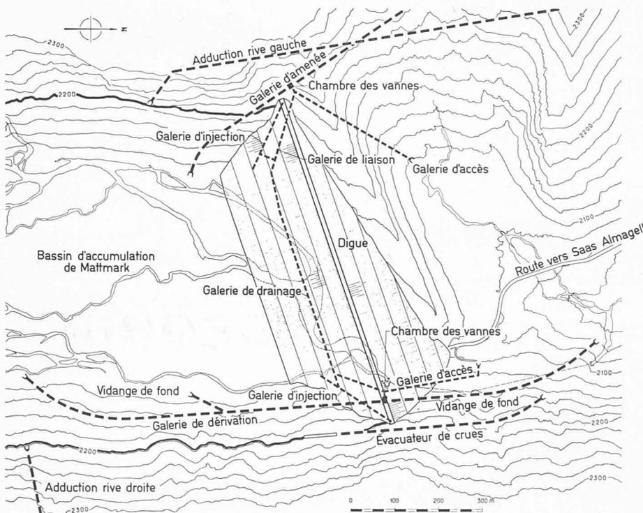
Fig. 9. — Situation de la digue et des ouvrages annexes.
