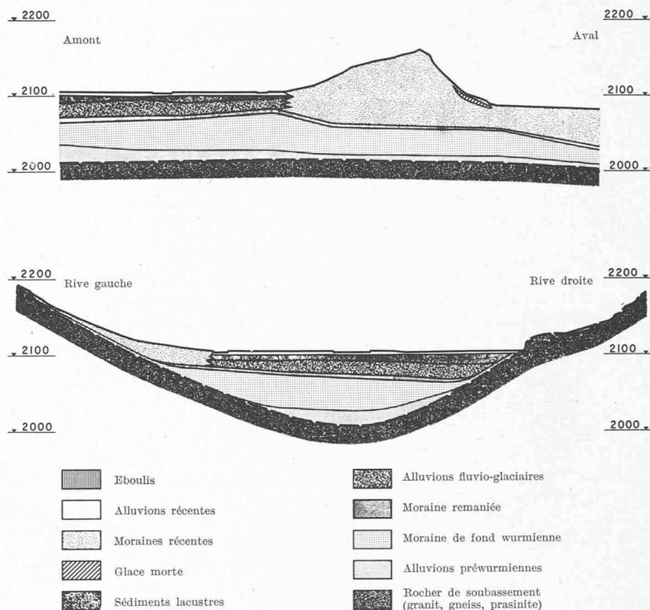
Fig. 7. — Coupes géologiques à l'emplacement de la digue.
