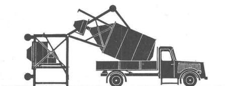
3. Le camion recule et met le support métallique en place.
