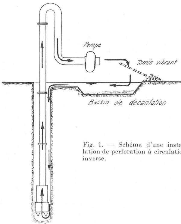
Fig. 1. — Schéma d'une installation de perforation à circulation inverse.
