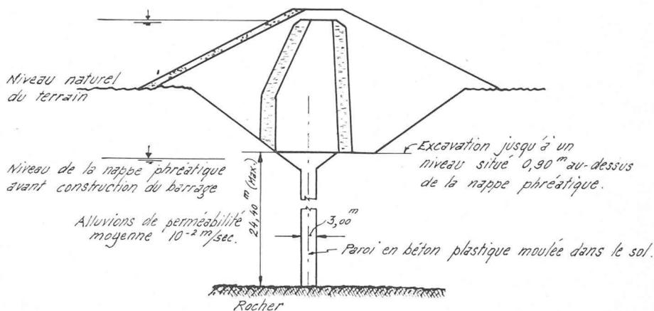
Fig. 4. — Coupe type du barrage de Wanapum.
