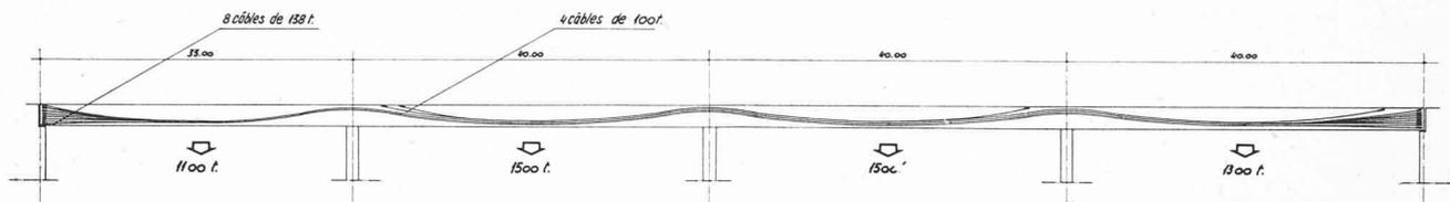
Fig. 4. — Tracé des câbles de précontrainte.
