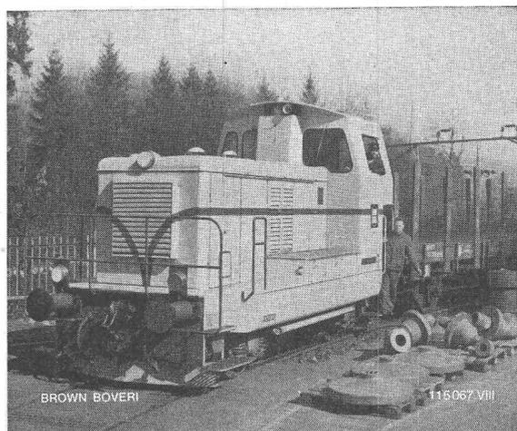
Locomotive diesel-électrique industrielle, 330 ch, pour le service de manœuvre de trains jusqu'à une charge au crochet de 1000 t.
