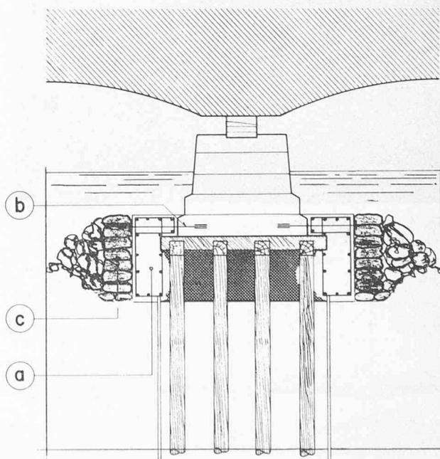
Fig. 5. — Coupe en travers d'une fondation renforcée.
