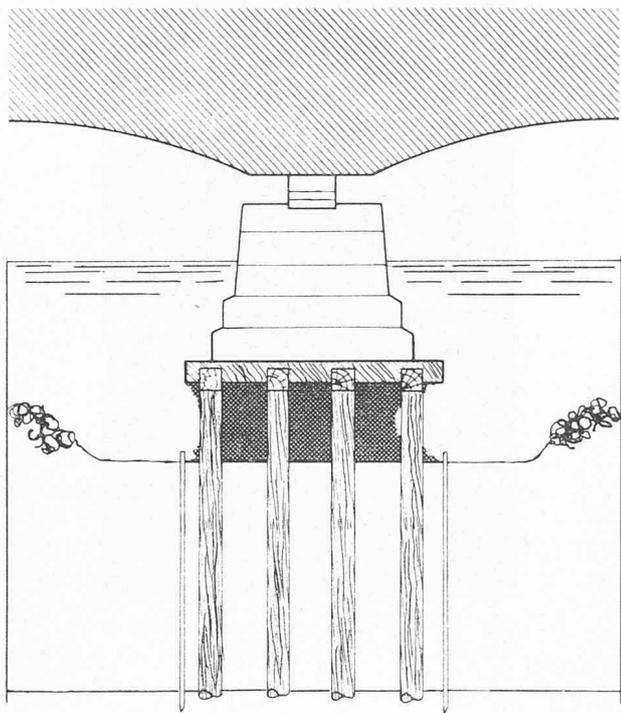
Fig. 3. — Fondation après travaux de nettoyage.
