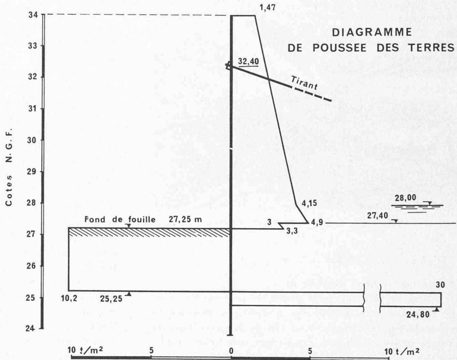
Fig. 2. — Diagramme de poussée des terres.
