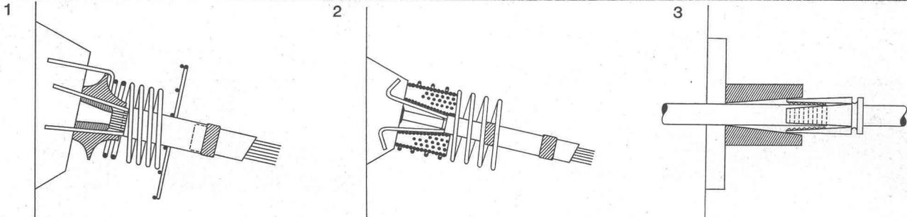
Les diverses unités Freyssinet de précontrainte — monofils jusqu'à 12 t, câbles à 12 fils jusqu'à 67,5 t, câbles à 12 torons jusqu'à 200 t — sont munies d'ancrages adaptés à chaque type. Mais tous ont un trait commun: une simplicité remarquable qui tient compte des conditions réelles régnant sur les chantiers et permet un travail accéléré.
