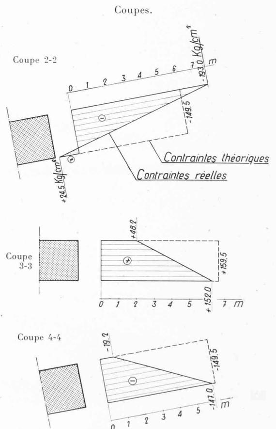
Les mêmes constatations peuvent être faites sur une photographie de la poutre soumise au cas de charge I de la figure 2. En confirmation du calcul classique, les diagonales ne subissent aucun effort, sauf la diagonale 2-3 qui est soumise à un moment fléchissant. L'examen qualitatif des photographies d'ensemble de la poutre nous permet de résumer son comportement par le schéma suivant :
