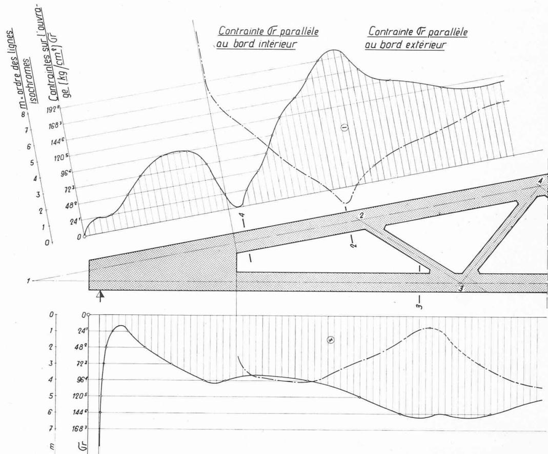
Fig. 6. — Modèle M<sub>2</sub>. Cas de charge III fig. 2. Contraintes sur l'ouvrage.
