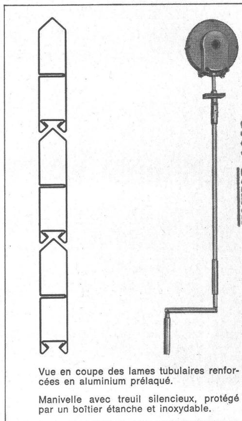
Vue en coupe des lames tubulaires renforcées en aluminium prélaqué.
