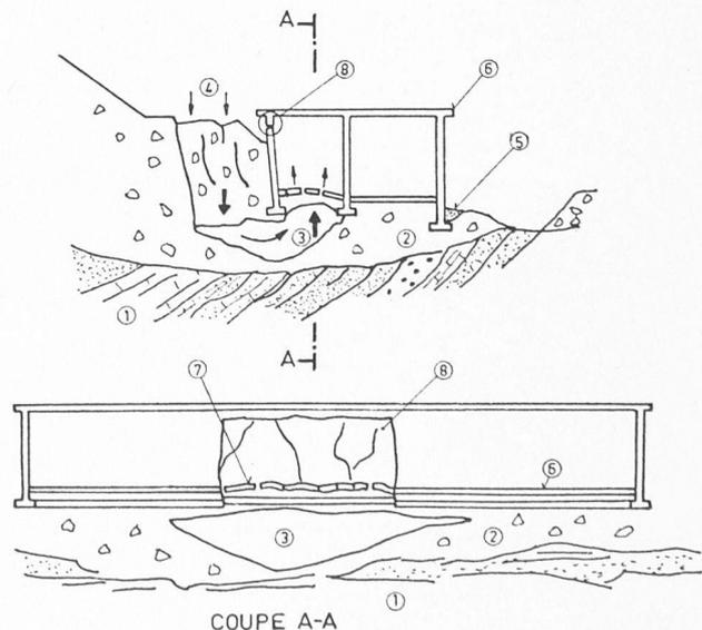
électrodes dans les files est de 1,5 m. L'eau est recueillie aux cathodes par un dispositif du type Well point. Les électrodes traversent l'argile liquide de part en part. Le courant est fourni par une génératrice débitant jusqu'à 150 ampères sous une différence de potentiel de 50 volts. L'installation travaille vingt-quatre heures sur vingt-quatre.
