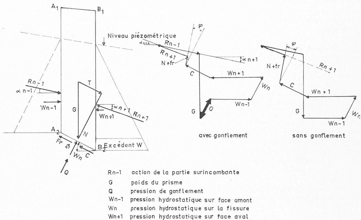
Fig. 5. — Forces agissant sur un prisme de terrain.
