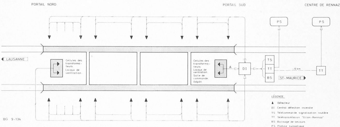
Fig. 9. — Détection incendie. — Schéma.
