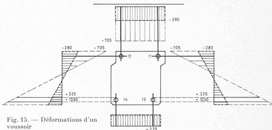
Fig. 15. — Déformations d'un voussoir calculées d'après les normes — en sections homogènes —
