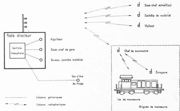
Fig. 25. — Réseau automatique d'interphones et de radio.
