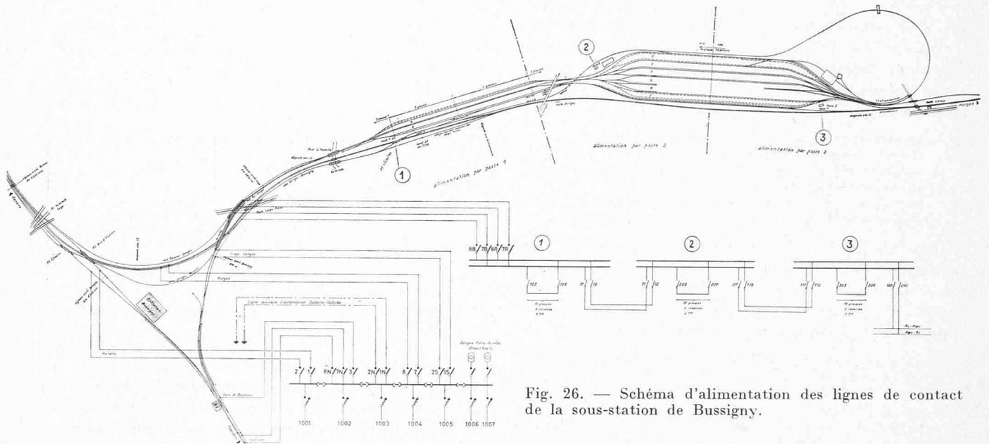
Fig. 26. — Schéma d'alimentation des lignes de contact de la sous-station de Bussigny.
